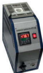
Калібратор температури KTT-150
